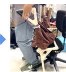
上右: 非線形ころがり杖による自動立ち上がり補助装置
