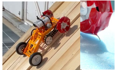
上: 適切な角度を持つニードルによる壁面移動機構
