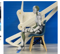
上右: 非線形ころがり杖による自動立ち上がり補助装置
